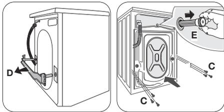
5. Снимите скобу **D**, завинтите шесть маленьких болтов **C** и снимите пластиковую шайбу **E**.
