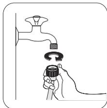
4. Присоедините наливной шланг к водопроводному крану с резьбой 3/4". Всегда используйте шланг, поставляемый вместе со стиральной машиной.
