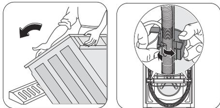
1. Po úplném odstranění obalů položte pračku opatrně na zadní stranu, abyste mohli odstranit polystyrénový podstavec ze spodní části spotřebiče.
