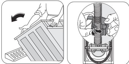
1. После снятия всей упаковки положите машину на заднюю панель, чтобы вынуть полистироловую прокладку из ее основания.
