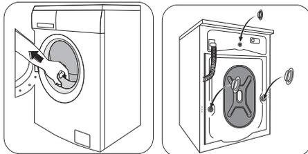
6. Откройте дверцу машины, достаньте наливной шланг из барабана и снимите полистироловую вставку, прикрепленную самоклеющейся лентой к прокладке дверцы.
