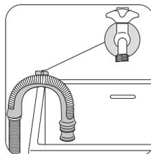
**Подвесить над краем раковины, используя пластмассовую направляющую, входящую в комплект поставки машины.** В этом случае убедитесь,
