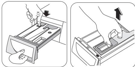
Для облегчения чистки можно снять верхнюю часть отделения для добавок. Извлеките дозатор, отжав вниз защелку и
