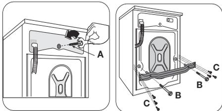
3. С помощью соответствующего гаечного ключа открутите и снимите центральный задний болт **A**.
