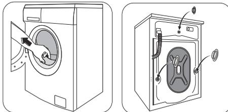
6. Otevřete dvířka, vytáhněte přívodní hadici z bubny a odstraňte polystyrénový blok, přilepený k těsnění dvířek lepicí páskou.
